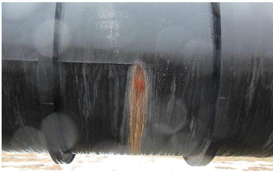
Рисунок 9 - Место образования дефекта снаружи дюкера
